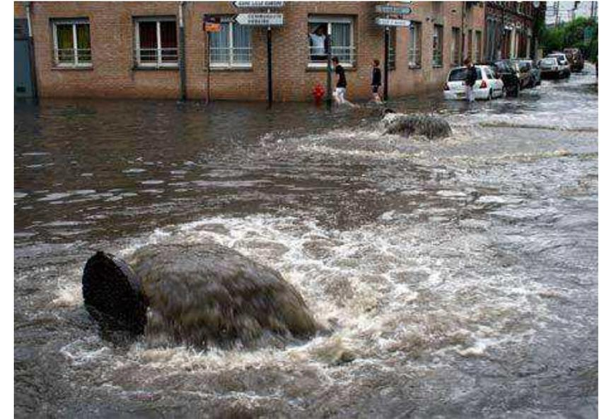
En moyenne annuelle, 10 % des effluents sont déversés sans traitement dans le milieu du fait de la collecte de la pluie par les réseaux
