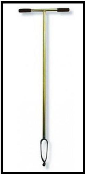
Les prélèvements à la tarière permettent de trouver des traces **d'oxydation (rouille)** et/ou de **réduction (gris-bleu)** de fer.
