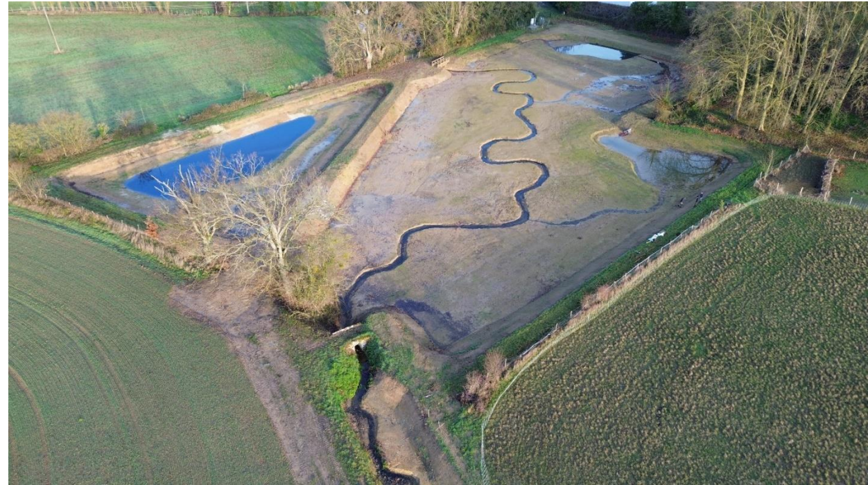
Après travaux, effacement des lagunes, cours d'eau méandrique et zone humide. Réduction du gabarit du cours d'eau.
