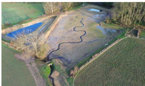
Après travaux, effacement des lagunes, cours d'eau méandrique et zone humide. Réduction du gabarit du cours d'eau.
