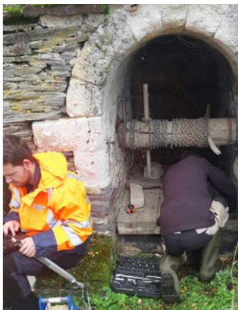
Equipement du puits d'Orgigné (Brissac Loire Aubance) pour le suivi des nappes.
